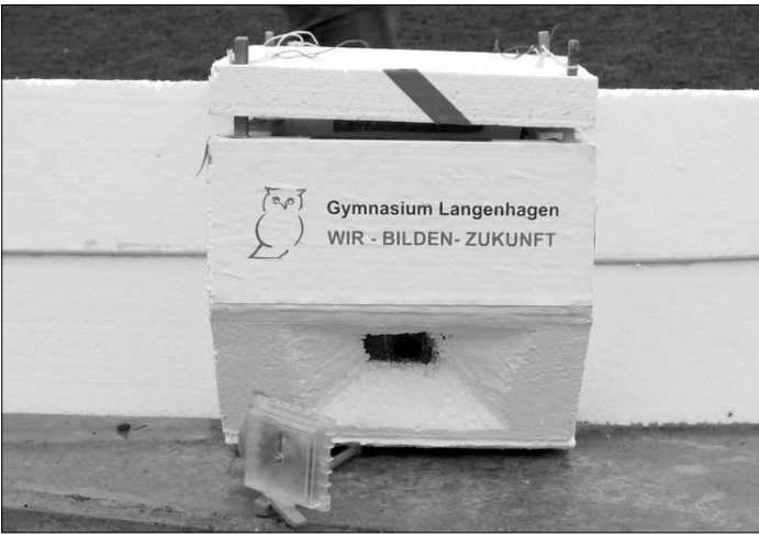
Die Wetterstation ist in einem Styropor-Kasten eingebaut.
